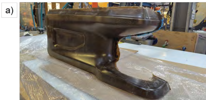
Abbildung 89: Mittelkonsolen-Struktur: a) infiltrierte, entformte und unbesäumte NFK-Halbschale; b) Zusammenbau der besäumten Mittelkonsolen-Struktur (eigene Darstellung)
