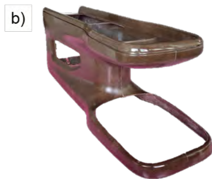
Abbildung 89: Mittelkonsolen-Struktur: a) infiltrierte, entformte und unbesäumte NFK-Halbschale; b) Zusammenbau der besäumten Mittelkonsolen-Struktur (eigene Darstellung)
