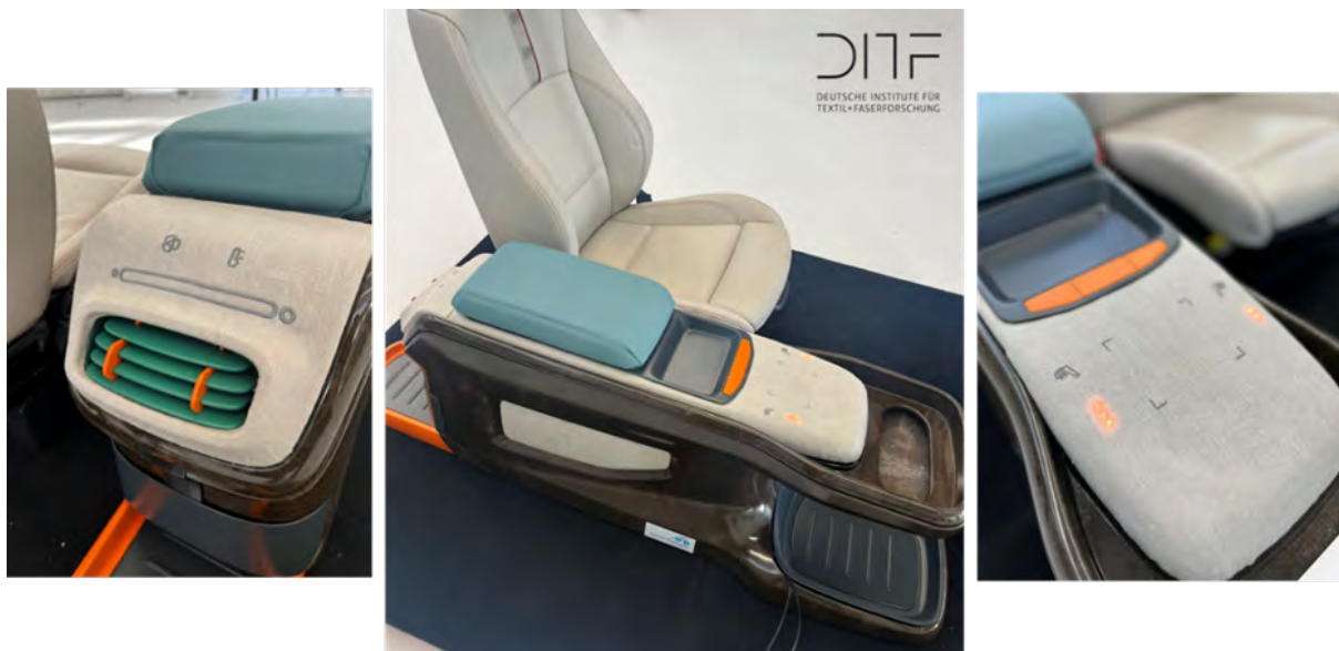
Abbildung 104: Umgesetzter Funktionalisierungskonzept an finaler Mittelkonsole (eigene Darstellung)
